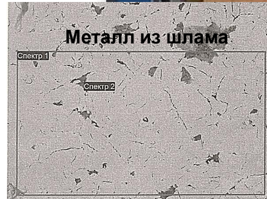
Состав чугуна: >96% Fe, примеси <0,2 мас.% S, <0,1мас.% Si
